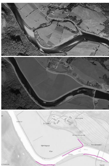
Figur 8.2. Flyfoto av området nedstrøms Bjørsetdammen 1937 (øverst) og 1985 (midt), på bildet fra 1985 er det tydelig av sideløpet rundt Kjerringøya er stengt av og fylt igjen samt at nordre bredde av Orkla er forbygd i hele utstrekningen i bildet (foto: Norge i bilder ). Den fulle utstrekningen av forbygginger er ikke registrert i NVEs database (nedre bilde, NVE Atlas ).
