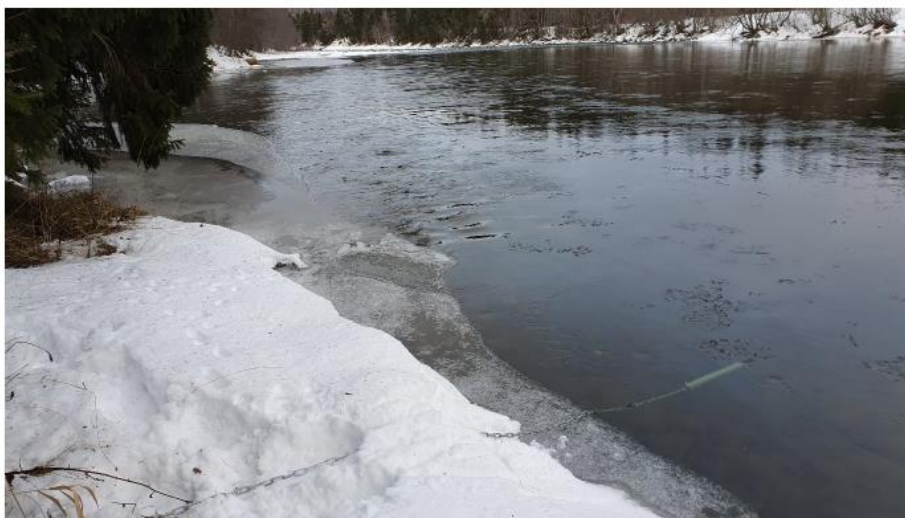
Figur 1 Loggerplassering ved Skjelsengenget. Kjettingen er festet til et tre på land, og i en bolt i jernrøret som ligger i vannet. Loggeren er inni jernrøret. Utløpsområdet, overgangen fra basseng til stryk, vises i bakgrunnen.
