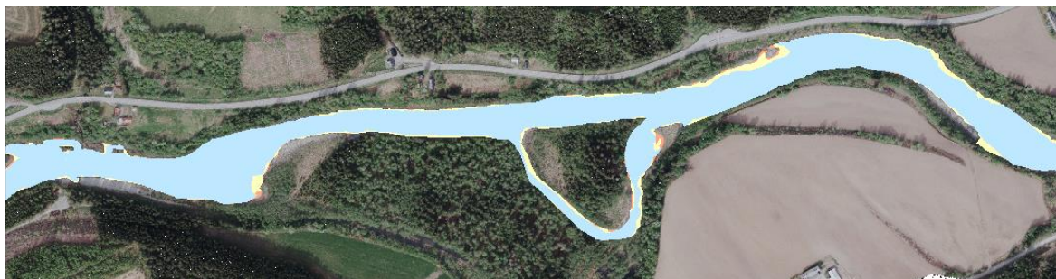
Figur 8.9. Digitaliserte vannoverflater fra flyfoto tatt på tre vannføringer, 11,9 m 3 /s (blå), 21,5 m 3 /s (gul) og 28-40 m 3 /s (rød).
