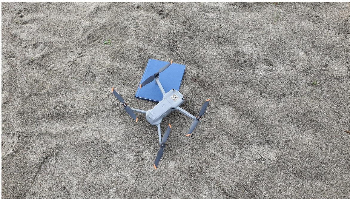
Figur 4.6. Dronen som ble brukt i dette forsøket var en DJI Mavic Air 2S. Foto: Megan Nowell
