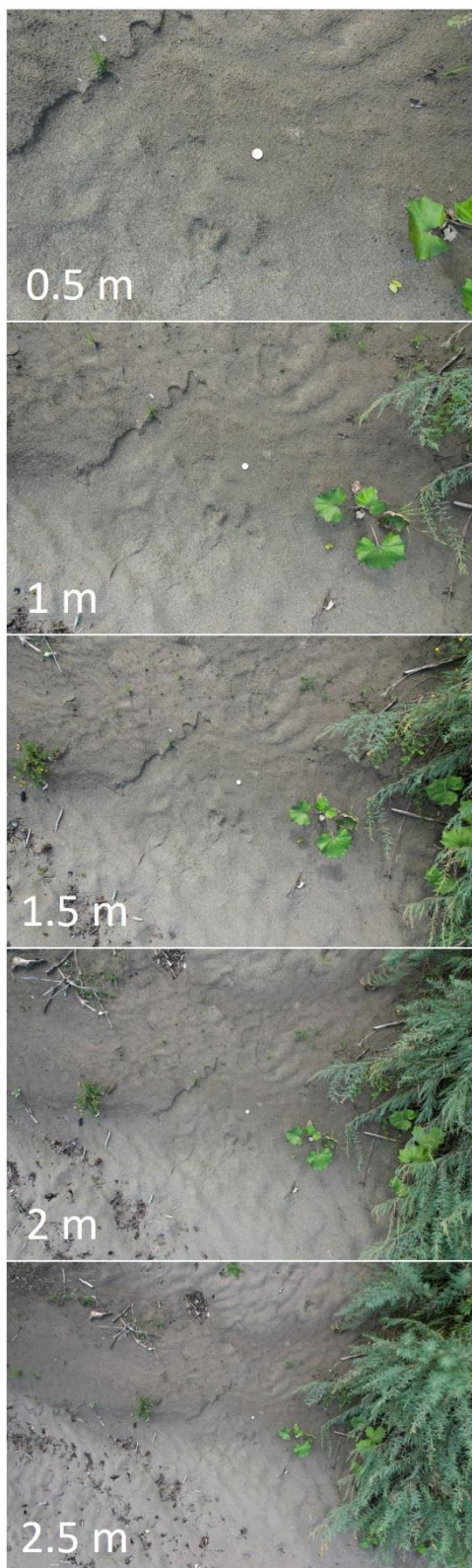
Figur 4.10. Bildene viser samme testområdet fra ulike flyvehøyder (0,5–2,5 m med 0,5 m intervall). En 20 kr mynt ble plassert i senter av bildene for skala.
