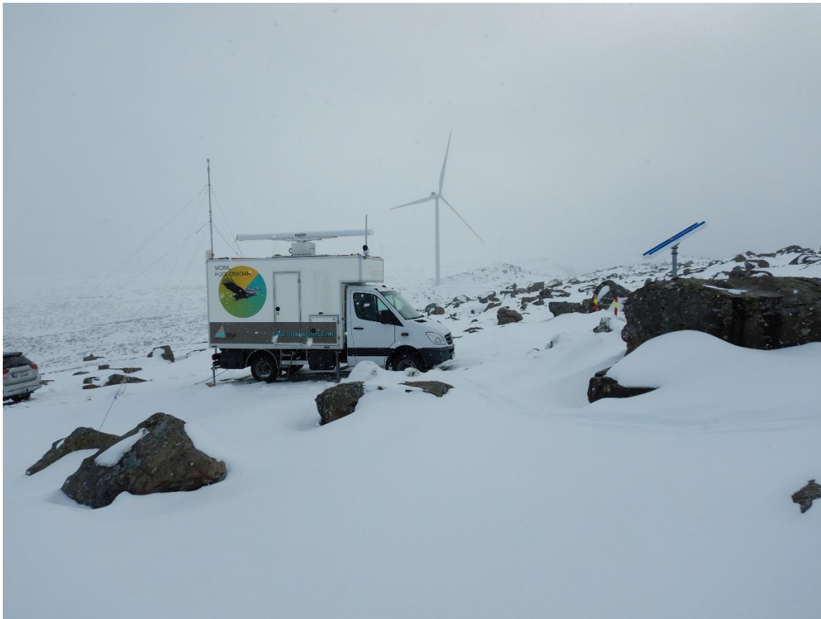
Figur 3. Vertikalradaren (montert på bakken) og horisontalradaren Robin 3D Flex, der sistnevnte er fastmontert på NINA sin mobile radarenhet. Foto: Arild Breistøl.
