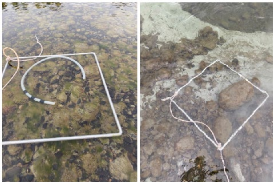
Figur 21. Utstyr for måling av hulrom i bunnssubstratet.
