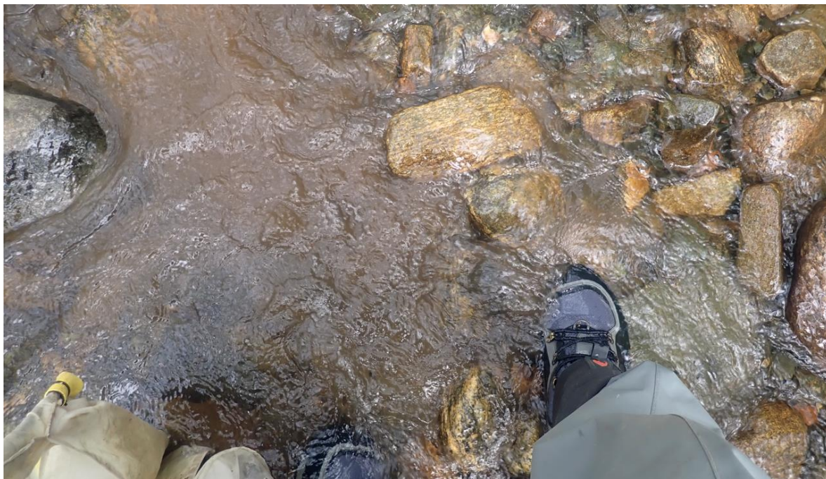
Figur 19. Ved bunndyrprøvetaking synliggjøres fortsatt betydelig med deponert jernslam på bekkebunnen også i nedre del av bekken. Dette ligger mellom og under steiner, og er ikke like lett synlig som lengre oppe. Trolig er jernutfelling betydelig også her under utslipp kombinert med høy vannføring i bekken. Foto: @Morten Andre Bergan
