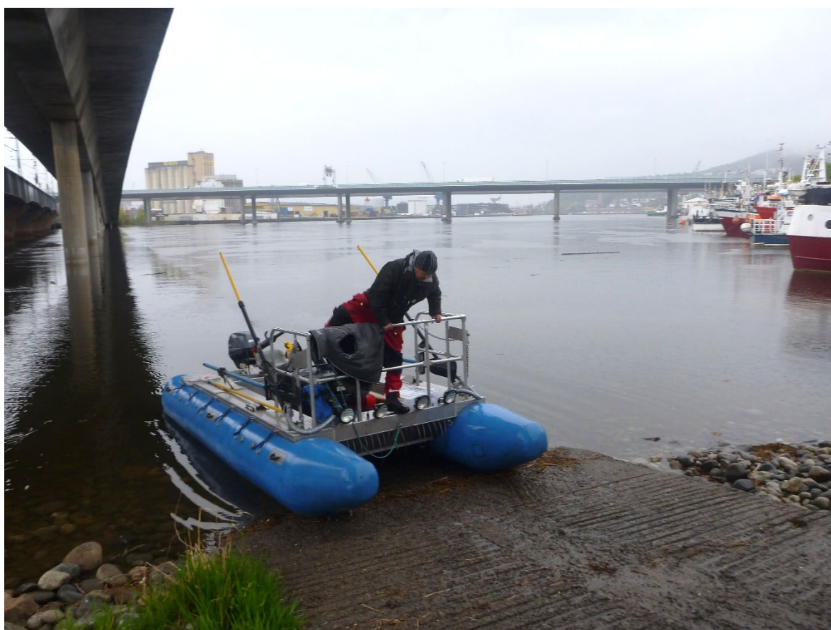
Figur 1. Den minste elektriske fiskebåten til NINA under utsetting nederst i Drammenselva. Foto: Tor Atle Mo
