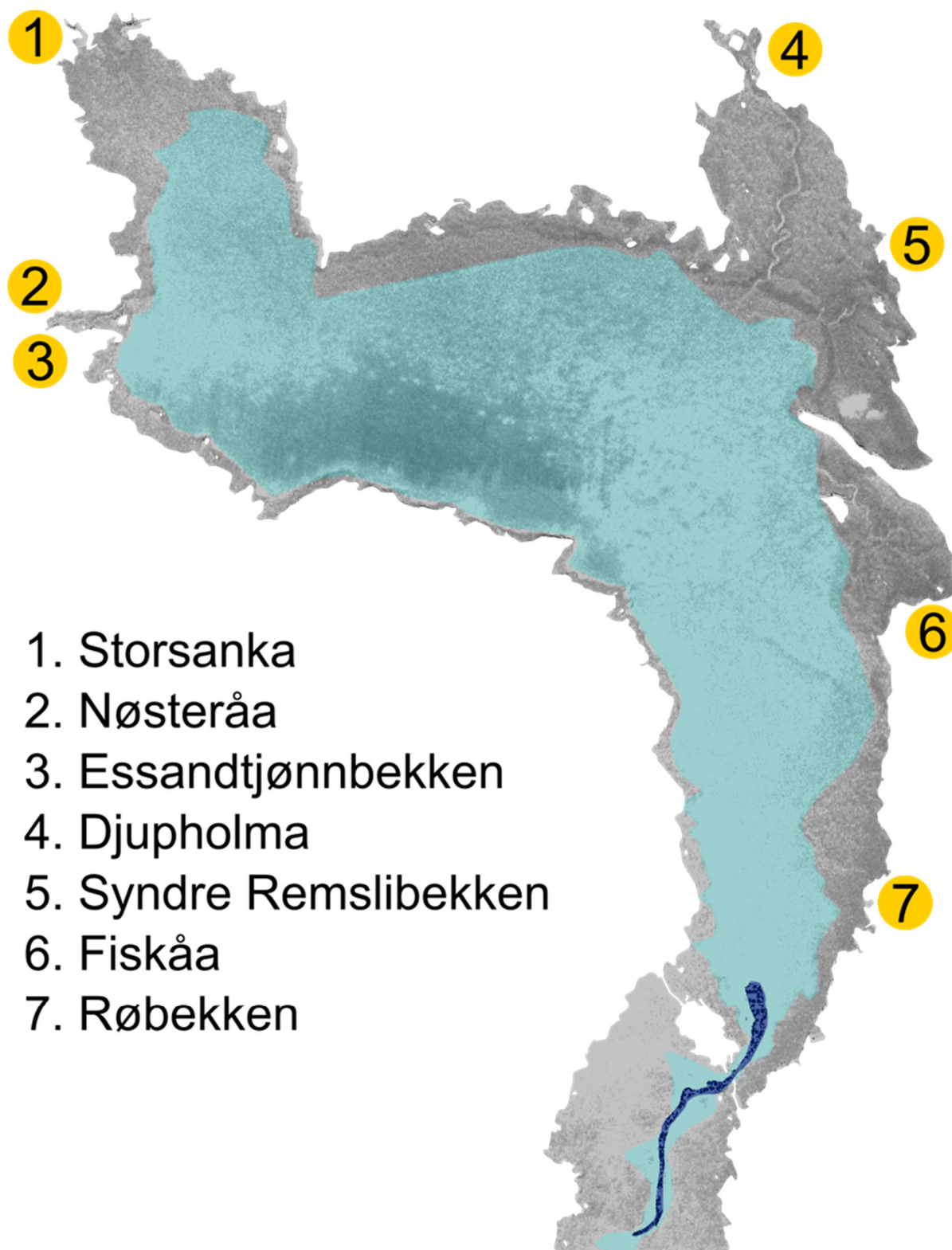
Figur: Satelittfoto (Sentinel 26.03.2020, NDVI, forsterket kontrast, sort-hvitt) over Essandsjøen. Isdekket (turkis) ligger omtrent ved LRV, mens omrisset er vannstand ved HRV. De befarte tilløpsbekkene og -elvene rundt Essandsjøen er merket med tall. I og rundt utløpet av Essand mot Nesjøen er det en åpen råk (mørkeblått). Kilde: Sentinelhub playground.
