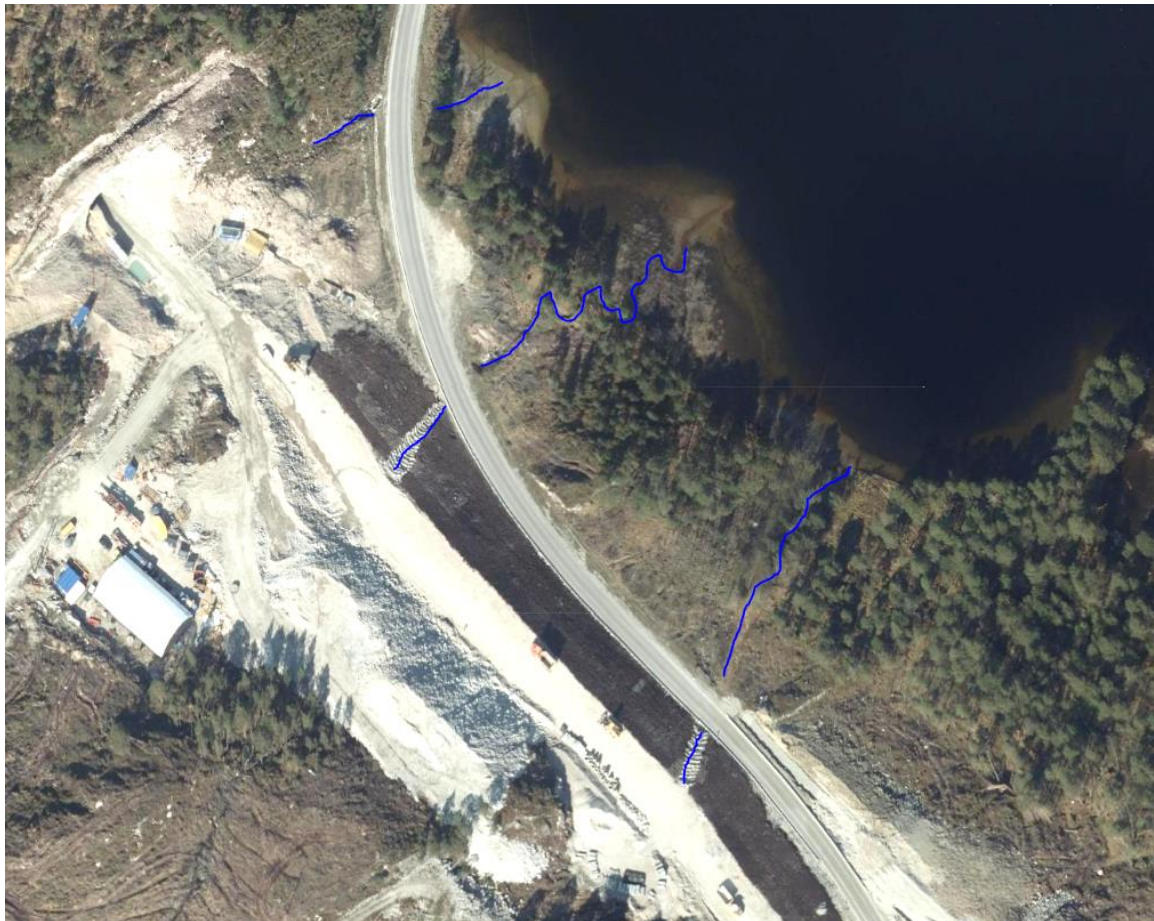
Figur 56. Små bekker er primær-resipienter for avrenning av partikler, slam og andre relaterte stoffer fra veiarbeidet med FV 714. Flyfoto fra 2019: https://kart.finn.no/
