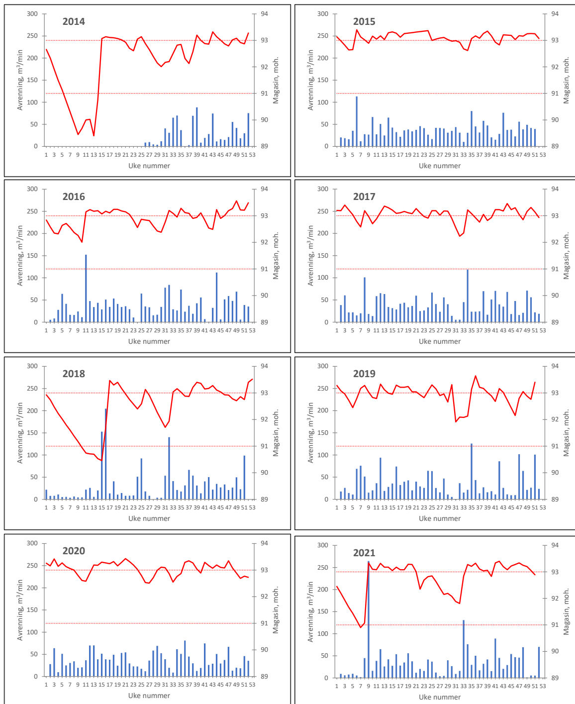
Figur 3. Vannstanden i Slørdalsvatnet (rød linje) og avrenning fra magasinet (blå stolper) angitt som ukesmidler for perioden 2014-2021. Stiplede røde horisontale linjer angir LRV og HRV (91-93 moh.). Måler med lagring av vannforbruk ble montert 23. juni 2014. Data fra MOWI AS Slørdal.
