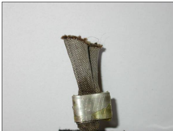
Figur 6.3. Nærbilde av festebåndet på sender nr 52456, funnet øst for Torneträsk. Det rene kuttet ser ut til å ha vært utført med en skarp gjenstand.
