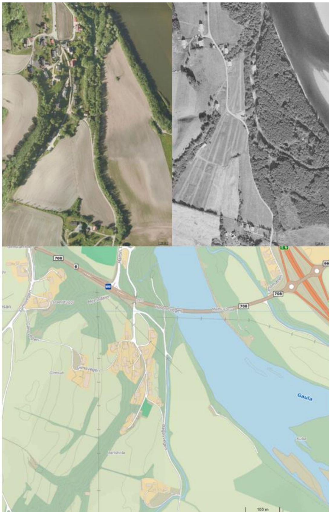
Figur 10. Flyfoto fra 2021 (øverst, t.v.) sammenlignet med 1957 (øverst, t.h.) avdekker omfattende grøfting, kanalisering og utretting av Moabekken i nedre del, der årsakene er knyttet til landbruk og anlegging av vei (kartutsnitt, nederst). Kart og flyfotogrunnlag: https://kart.finn.no/
