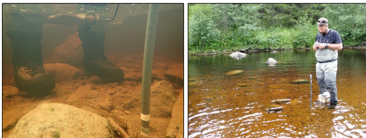
Figur 12. Måling av redokspotensial i substratet. Foto: Bjørn Mejdell Larsen.
