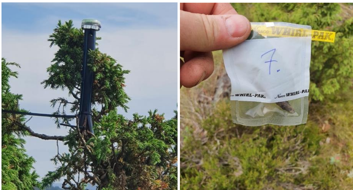
Figur 6.1. Lyslogger montert i toppen av en einer (venstre) og prøve av smørbukk til tungmetallanalyse (høyre). Foto: Anders Endrestøl.
