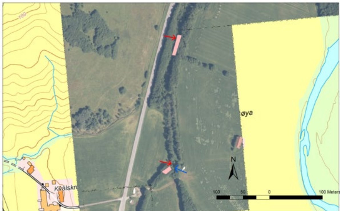
Figur 2. Områder med forslag til tiltak i Kjelbekken nedstrøms Fv. 65. Blå piler er forslag til opprettelse av kulper, røde piler er forslag til skjulområder og rosa polygon er områder der det foreslås å legge ut gytesubstrat.
