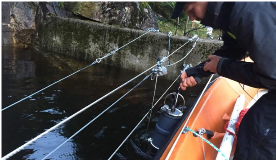
Karl Øystein Gjelland henger på plass lyttebøyer for posisjonering av laks ved inntaket til Laudal kraftverk, Mandalselva. (Foto: Henrik Baktoft)
