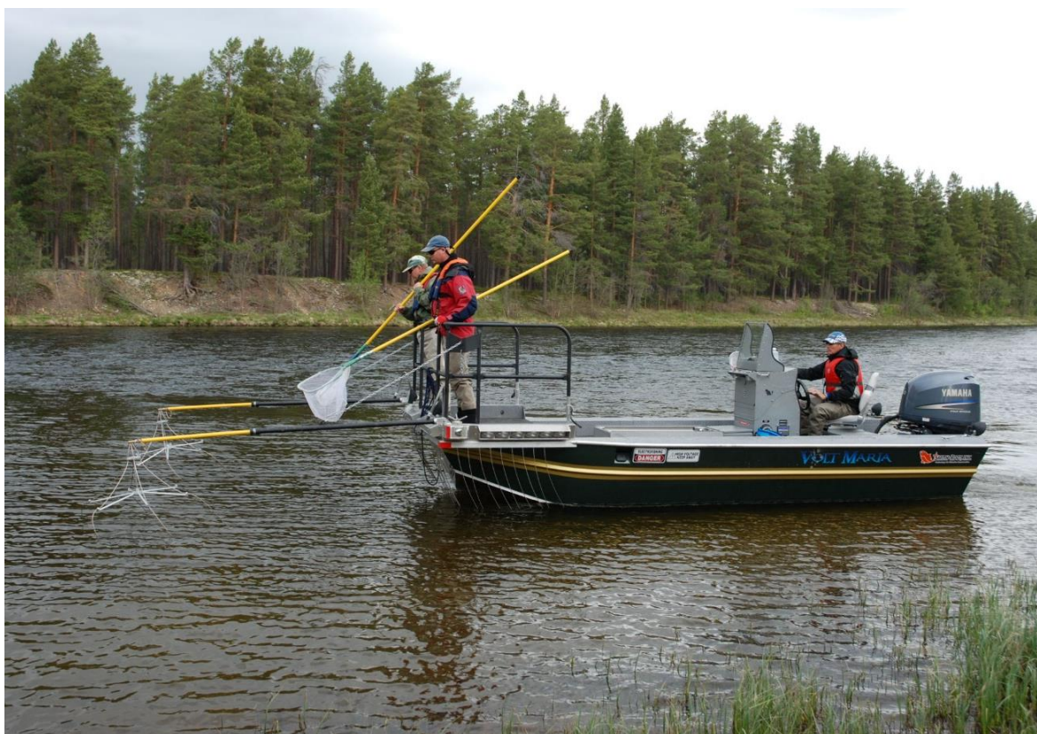
Bilde 2. I perioden 2016-2019 ble det under det elektriske båtfisket i Røssåga benyttet en 18 fots aluminiumsbåt utstyrt med vannjetmotor. Illustrasjonsbildet er fra en tilsvarende undersøkelse som ble gjennomført i Rena i 2011. Foto: Jon Museth.
