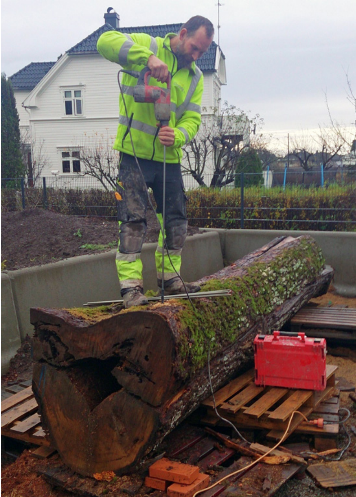
Figur 9. De to delene av stokken tilpasset og plassert på hverandre; her blir hullene til gjen- gestengene boret. Bildet er tatt 24. november 2014. Foto: Magne Flåten.
