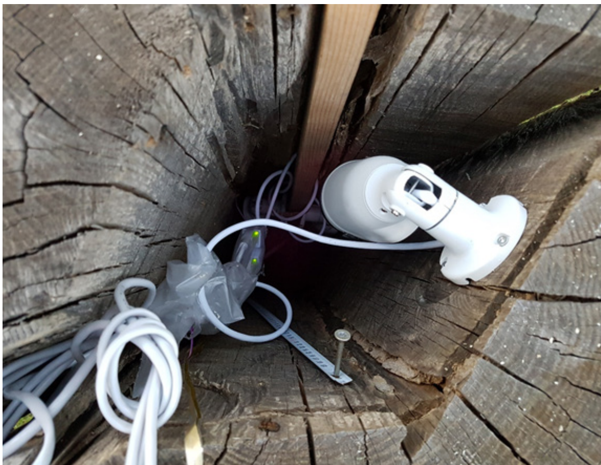
Figur 36. Tre IP kamera montert i eikestokken 19. juli 2017 – to parallelt nede i hulrommet, mens ett er plassert noe høyere. Foto: Anders Endrestøl.
