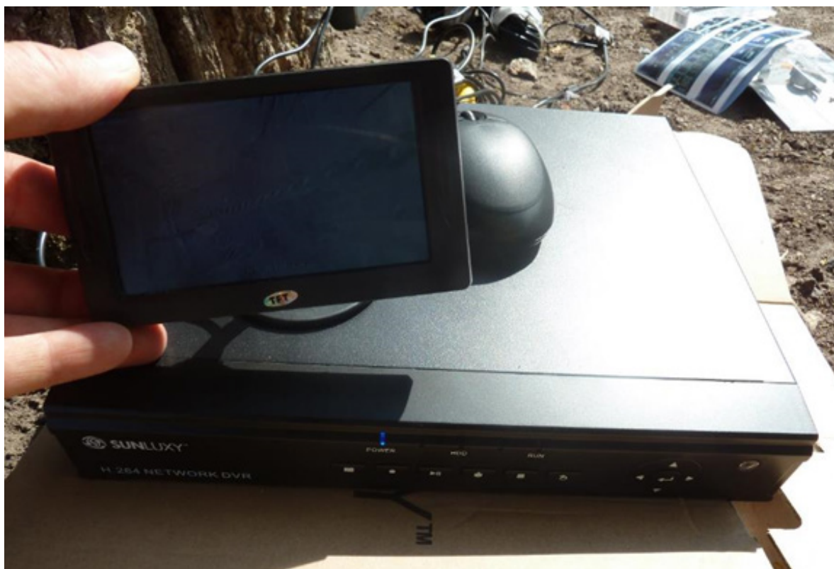
Figur 21. Montering og kalibrering av videoutstyr for overvåking av eremitt V. Her ser man opp-taksenheten Sunluxy 4 Channel D1 som ble benyttet. I denne ble det satt inn en 250GB SSD harddisk. Foto: Ronny Steen.
