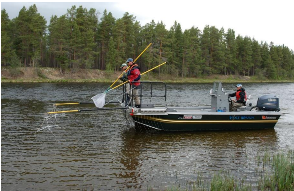
Bilde 3. Under elektrisk båtfiske i fire elver på Sørlandet høsten 2019 ble det benyttet en 18 fots aluminiumsbåt med en 200 hestekrefters utenbordsmotor med vannjet. Illustrasjonsbildet er fra en tilsvarende undersøkelse som ble gjennomført i Rena. Foto: Jon Museth.
