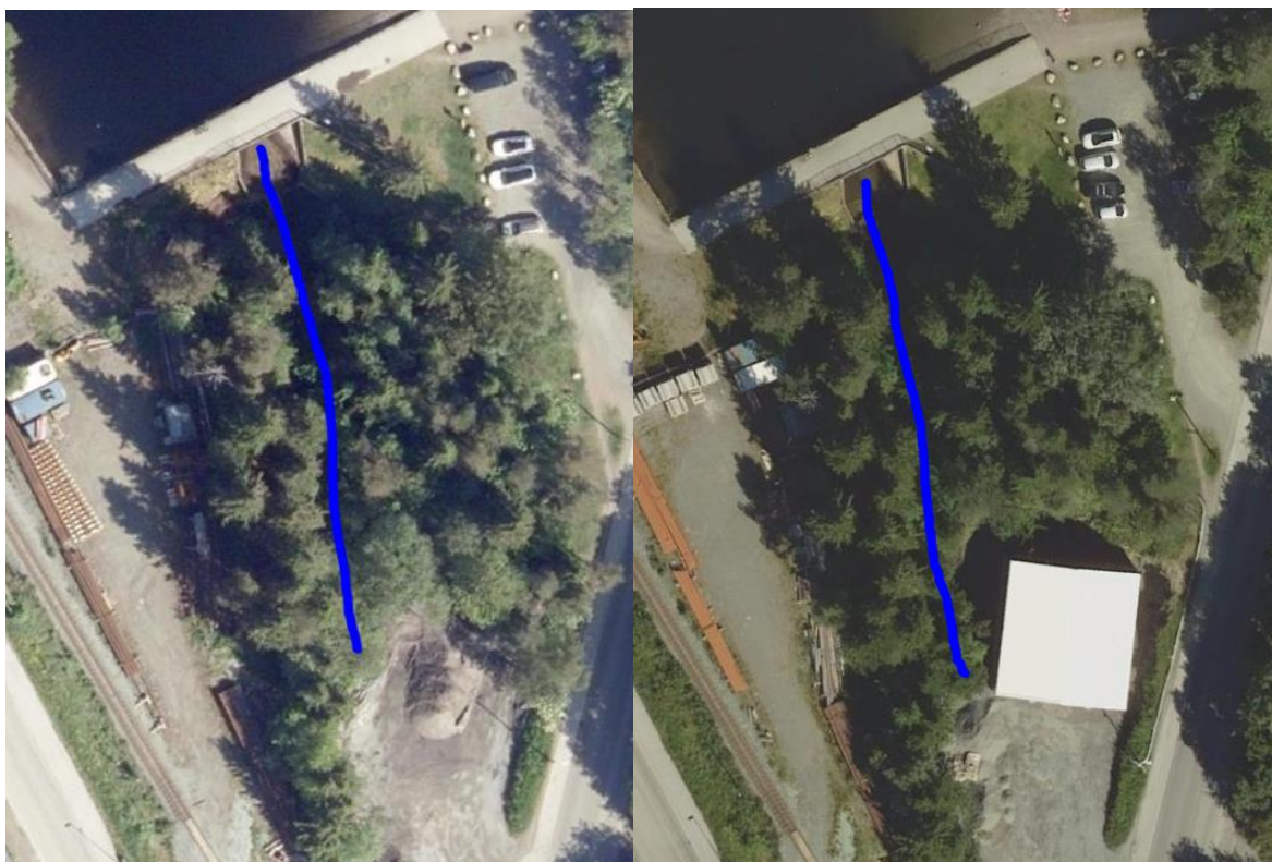
Figur 24. Avrenning fra forurenset feiemasse og finstoff rett i bekkeløpet har hatt negativ effekt på Uglabekken fram til 2019 (flyfoto til venstre). Problemet ble løst ved bygging av hall i 2020 (flyfoto til høyre). Blå linje er Uglabekken på strekningen fra overløp demning Kyvatnet til lukking ovenfor Nedre Ferstadveg. Bekkestrekningen er også vist i figur 3 . Flyfoto: https://kart.finn.no/ .
