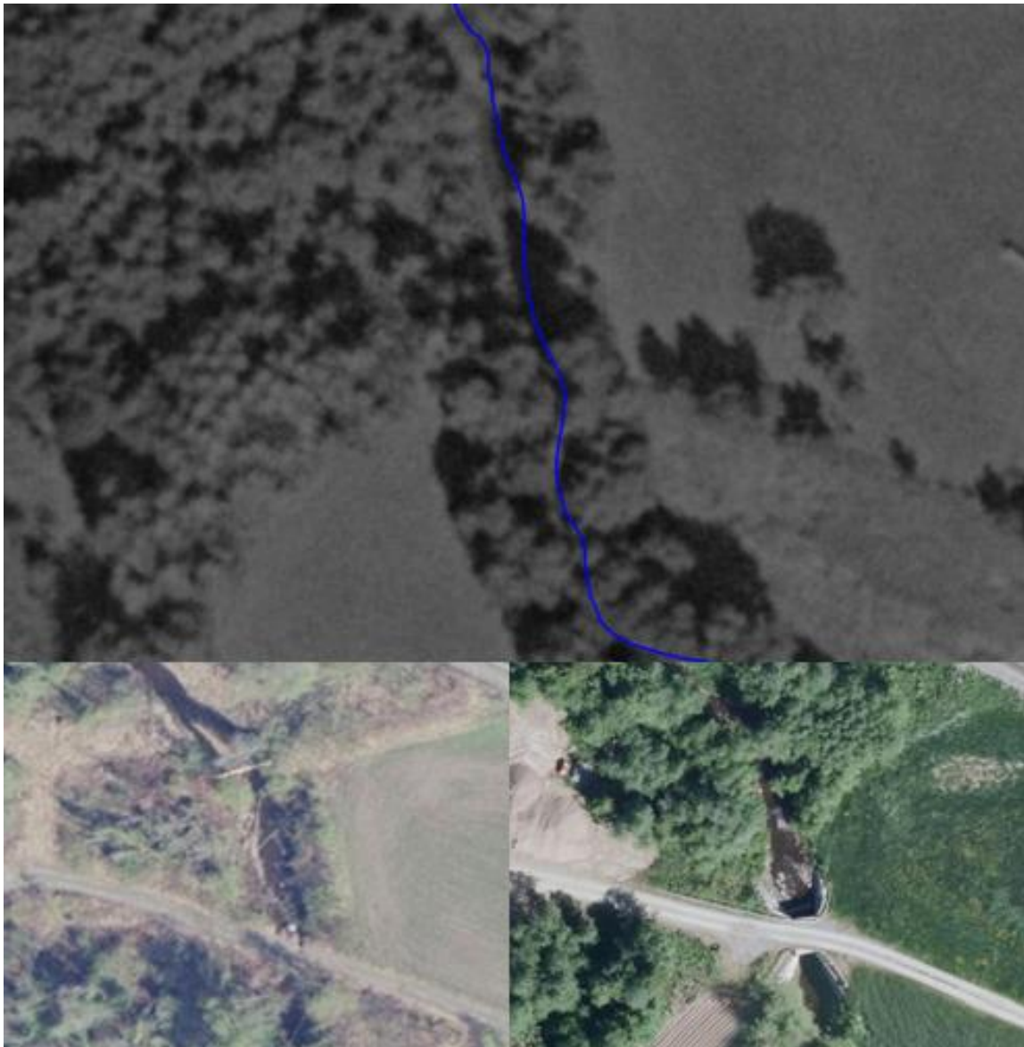
Figur 59. Folstadbekken i 1956 (øverst). Etter 2002 (t.v.) dukker en grusvei opp i nedre del av Folstadbekken, med tydelig innsnevret kulvert. Bekkekrysningen endres radikalt etter 2010 (t.h.). Interessepunktet må avklares for fiskevandring. Flyfoto: https://kart.finn.no/
