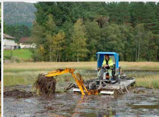
Figur 3. Amfibiegravemaskin ble brukt i restaureringstiltaket for å få fjernet biomasse. An amphibian machine was used in the restoration project to remove biomass. Foto/Photo: M. J. Steinsvåg.
