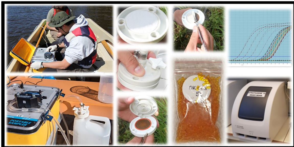
Figur 4.2. Vannprøver på ~5 liter ble filtrert på stedet ved hjelp av en portabel peristaltisk pumpe. Filterene ble overført til ziplockposer med silica gel for oppbevaring frem til analyse som vist på bilder, eller puttet på rør med buffer. DNA ble isolert med en CTAB ekstraksjonsmetode eller NucleoSpin Plant II Midi kit (Macherey-Nagel) og deretter ble tilstedeværelsen av miljø-DNA fra edelkreps og signalkreps undersøkt med qPCR.
