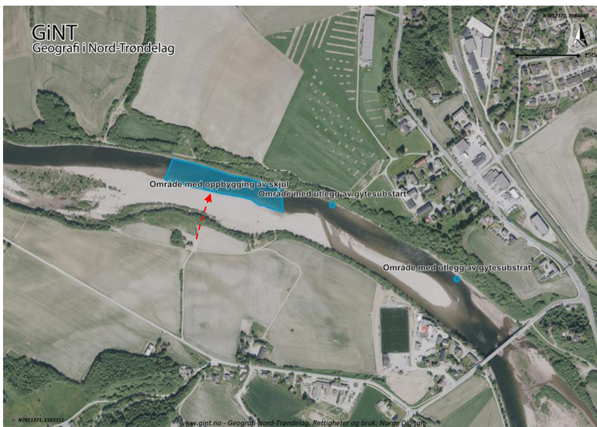
Figur 10. Områder nedstrøms Kvålsbrua med foreslåtte tiltaksområder (blå markering). Det foreslås å legge ut gytesubstrat langs elvebredd som ved høy vannføring og flom skal bidra til å dekke de eroderte områdene, og samtidig danne nye gyteområder. I det skraverte (15 000 m 2 ) foreslås etablering av steinrygger som skal danne skjulområder. Rød pil angir tilkomstvei.
