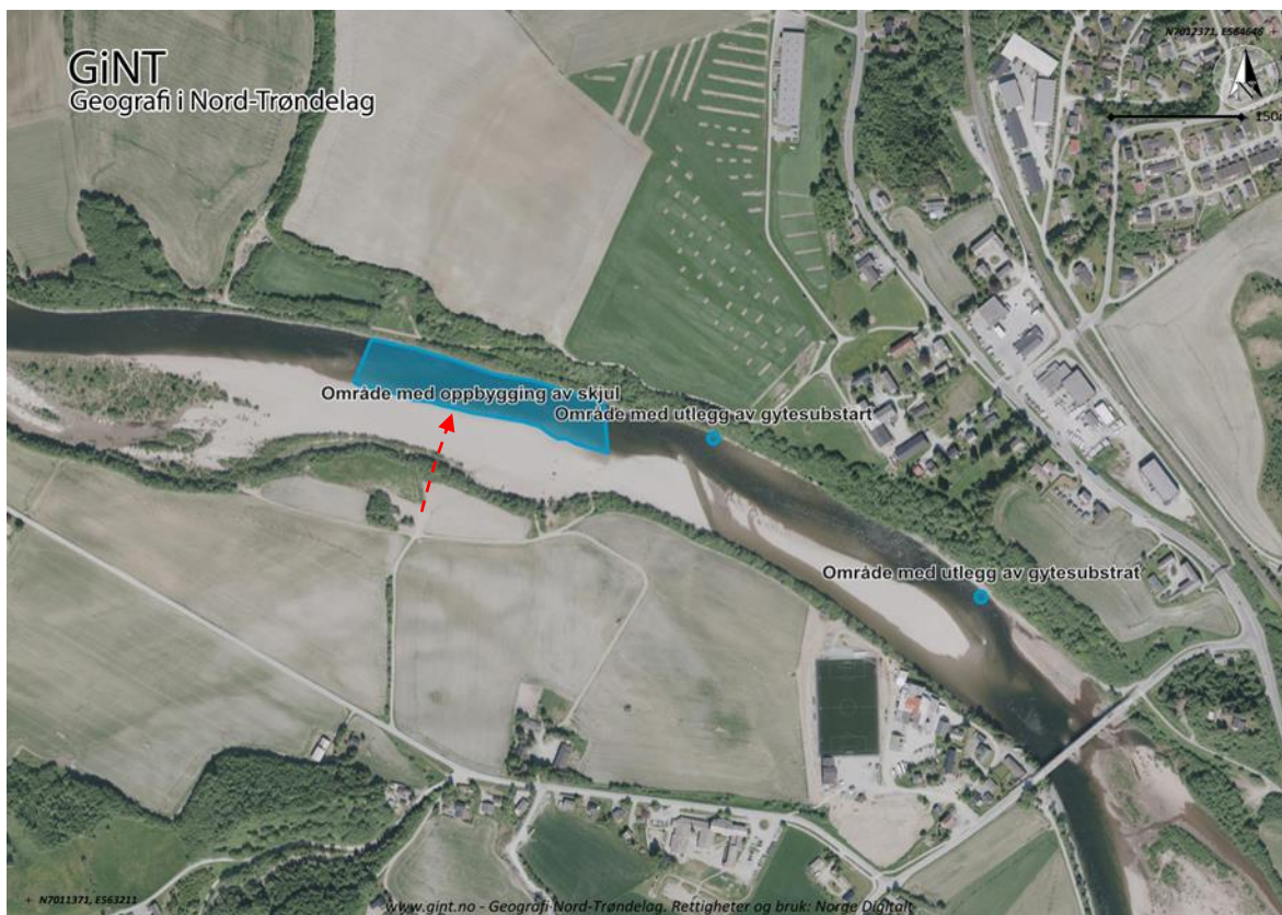
Figur 21. Områder nedstrøms Kvålsbrua med foreslåtte tiltaksområder (blå markering). Det foreslås å legge ut gytesubstrat langs elvebredd som ved høy vannføring og flom skal bidra til å dekke de eroderte områdene, og samtidig danne nye gyteområder. I det skraverte feltet med et areal på rundt 15 000 m 2 foreslås etablering av steinrygger som skal danne skjulområder. Rød pil angir tilkomstvei. Figuren er hentet fra Holthe mfl. (2019).
