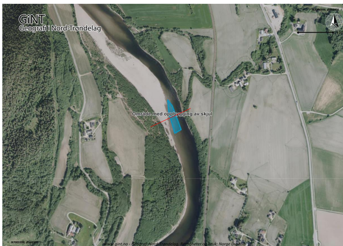
Figur 2. Lokalisering av foreslått pilotområde ved Nedre Leberg (blå skravering). I tiltaksområdet legges det ut to langsgående steinrygger som skal bidra til å øke skjulkapasiteten i området. Rød linje refererer til figur 3.
