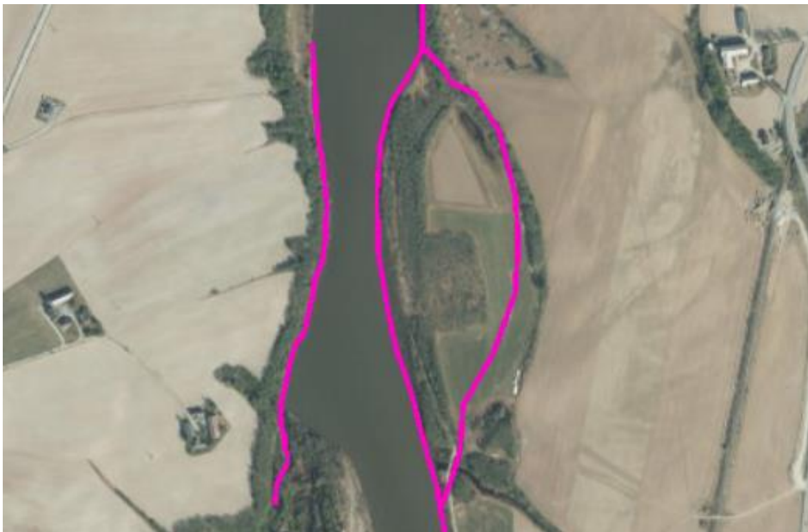
Figur 8. Eksempel på omfattende forbygningsaktivitet (markert med fiolette linjer) i et elveavsnitt ved Ler oppstrøms Gammeelva. Kilde: www.atlas.nve.no .
