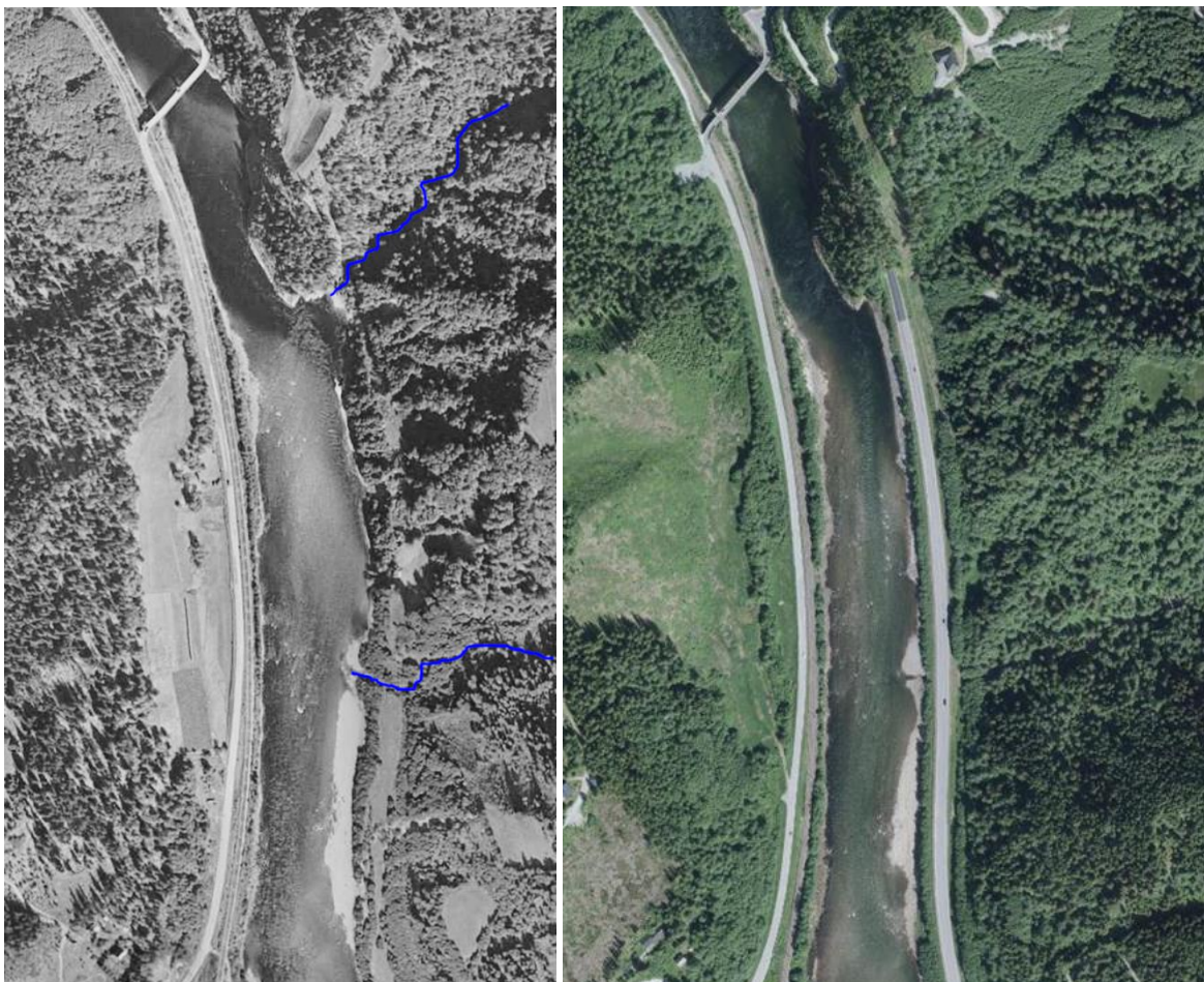
Bildeserie 3. Flyfoto fra 1956 (venstre bilde) og 2018 (høyre bilde) av Gaula oppstrøms Håggåbrua. Veifyllingene på østsida har medført store belastninger på to sidevassdrag (blå linjer). Ræa (lengst ned på bildet) har kulvert med vanskelige oppgangsforhold for laks og sjøørret. Hundåa (øverst på bildet) munner ut i et rør i veifyllingen, og anses i dag som et tapt leveområde for sjøørret. Kilde: www.kart.finn.no .
