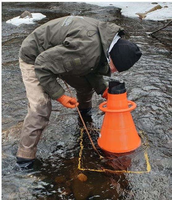
Figur 3. Standardiserte skjulmålinger gjennomføres etter Forseth og Harby (2013) ved registrere hvor mange ganger en 13 mm tykk plastslange kan føres inn i hulrom mellom steiner.
