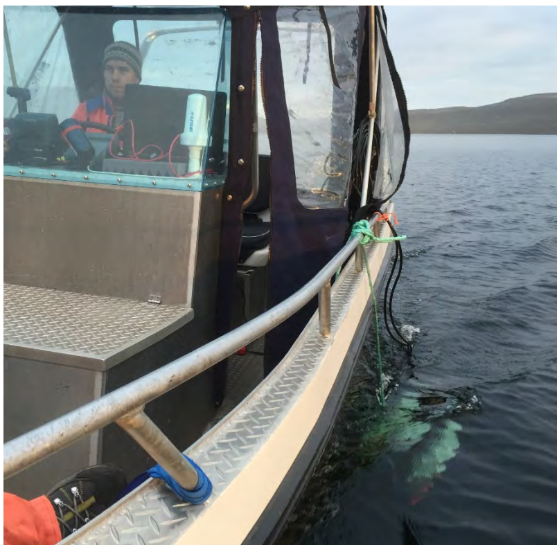
Figur 3. Svingeren var festet til en vinge som ble hengt fra båtsiden på 1 m dyp. Dette sikrer en mer stabil gange for svingeren enn om den er festet fast til båten. Foto: Karl Ø. Gjelland, NINA.
