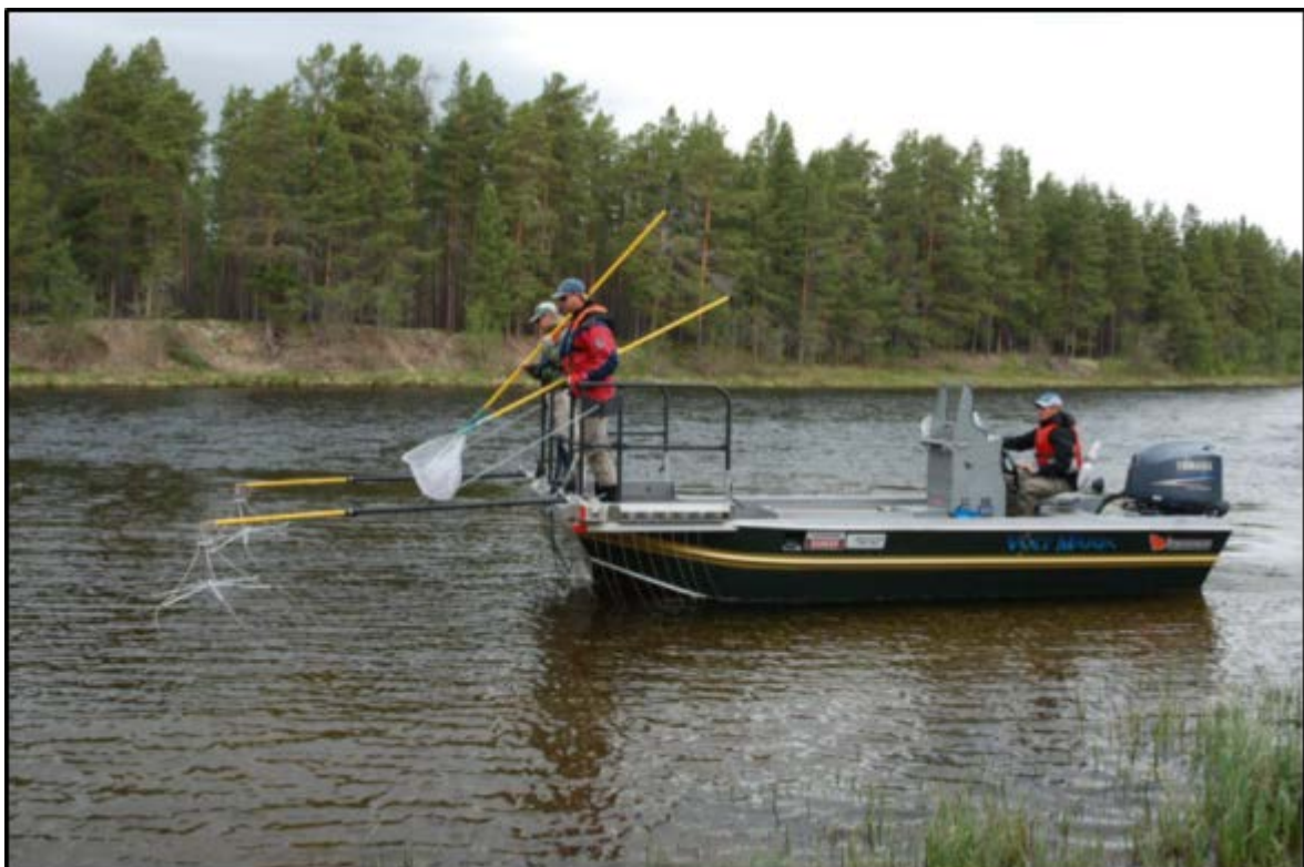
Bilde 3. Under det elektriske båtfisket i 2016 og 2017 ble det benyttet en 18 fots aluminiumsbåt med en 200 hestekrefters utenbordsmotor med vannjet. Illustrasjonsbildet er fra en tilsvarende undersøkelse i Rena. Foto: Jon Museth, NINA.
