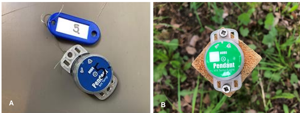
Figur 3.1.3 Datalogger for jordtemperatur (HOBO Pendant MX Temp MX2201) med snøre og tilhørende merkelapp (A) og lys- og lufttemperatur (HOBO Pendant MX Temp/Light MX2202) montert på toppen av en påle (B). Foto: H. Myklebost.
