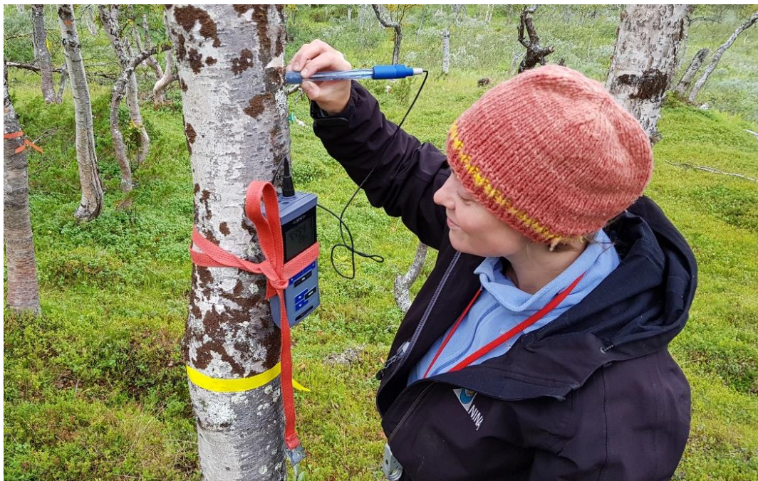
Figur 3.2.3 Måling av barkens pH i felt. Foto Magni O. Kyrkjæide, Dividalen 2018.
