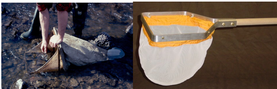
Figur 3.1.1. Surbersamplers og sparkehåv finnes i flere utgaver. Prinsippet er det samme: Med sparkehåven rygger man motstrøms og sparker opp bunnen slik at håven siler substrat og organismer som virvles opp. Surbereren skal samle organismene som finnes innen et kjent areal, definert av bunnrammen.
