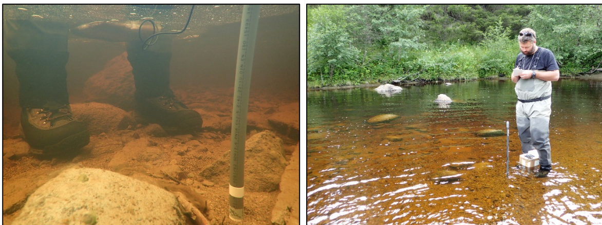
Figur 7. Måling av redokspotensial i substratet. Foto: Bjørn Mejdell Larsen.
