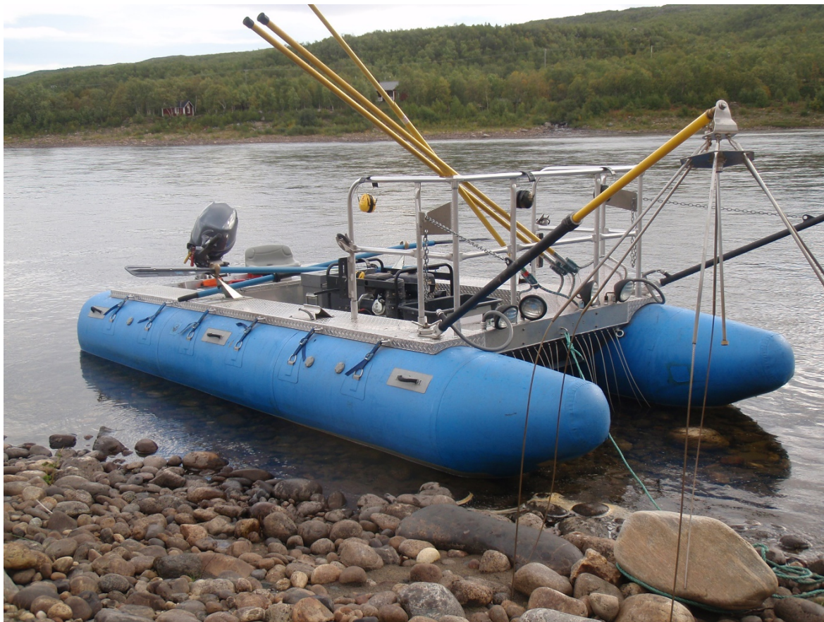
Bilde 1. Under elektrisk båtfiske i Orkla i oktober 2019 ble det benyttet en RIB-båt som kan operere i til dels svært grunne elveparti. Illustrasjonsbildet er fra en undersøkelse i Tanaelva i september 2014. Foto: Gunnbjørn Bremset.
