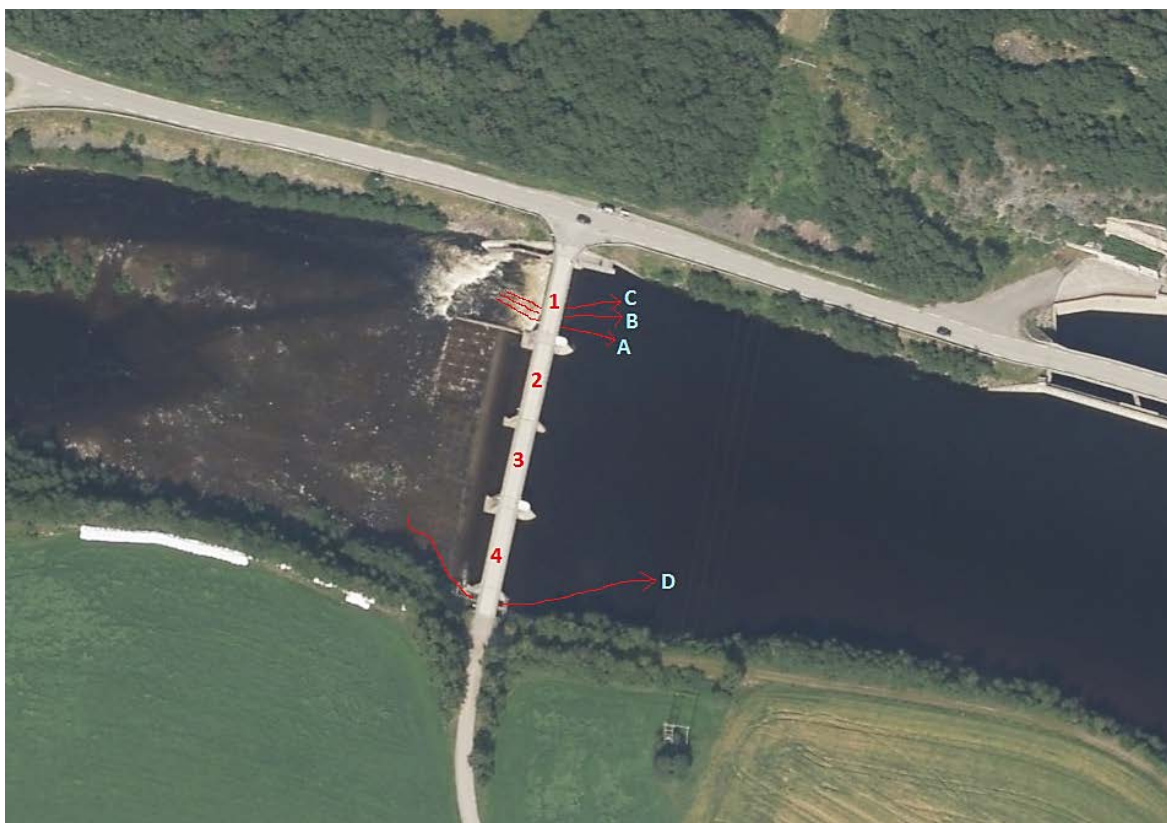
Figur 2. Flyfoto av Bjørsetdammen med de fire åpningene (lukene) i dammen, nummerert fra 1 til 4. Fisken passerer hovedsakelig i åpning 1. Her velger fisken ulike vandringsruter markert med A, B og C, men over 80 % vandrer langs rute A. Det kan også vandre fisk i fisketrappa på vestsiden av dammen (vandringsrute D). Hver av åpningene 1 til 4 er utstyrt med reguleringsluker som kan legges ned. Lukene i åpning 2 til 4 er kun åpne i flomperioder, og representerer ikke et reelt vandringsalternativ. Flyfoto er lastet ned fra www.finn.no .
