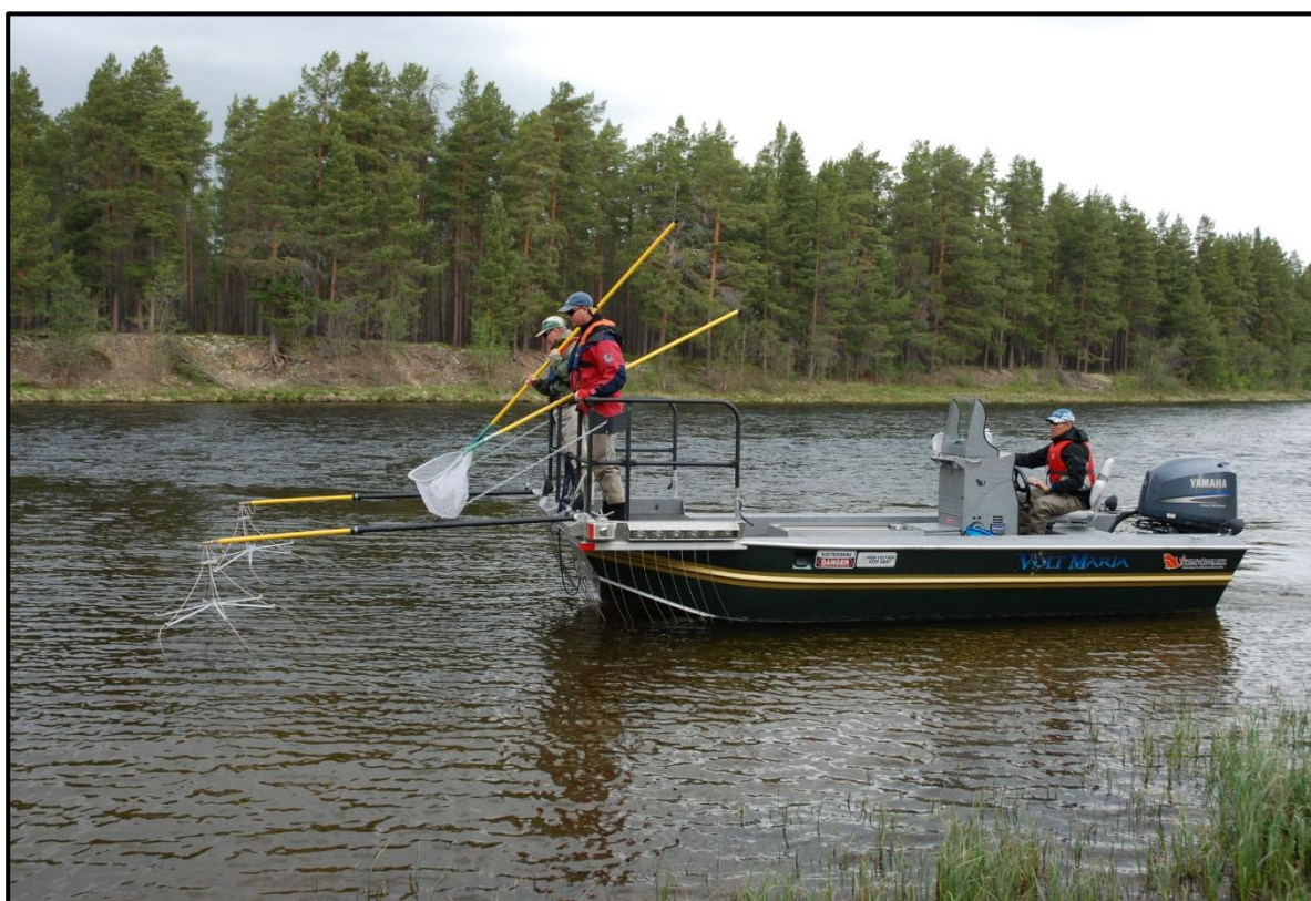
Bilde 1. Under det elektriske båtfisket ble det benyttet en 18 fots aluminiumsbåt med en 200 hestekrefters utenbordsmotor med vannjet. Illustrasjonsbildet er fra en tilsvarende undersøkelse i Rena. Foto: Jon Museth.
