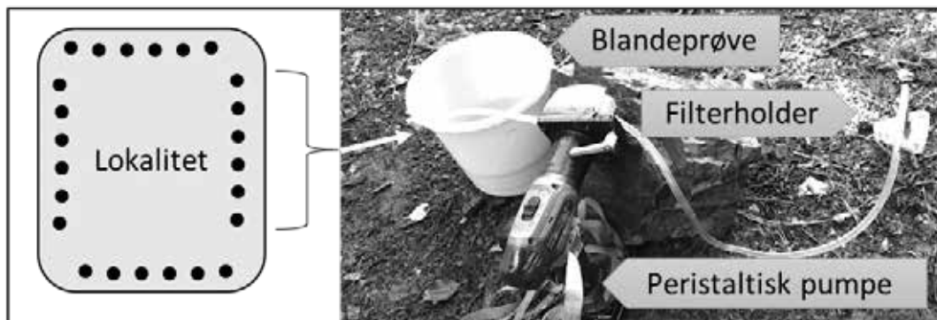
Figur 2 illustrerer innsamlingsstrategi og prøvetakingsutstyr. For hver lokalitet ble det samlet inn fire blandeprøver. Blandeprøvene ble laget ved å samle inn ca 0.5 L vann fra flere steder langs et strekke der antall småprøver varierte mellom 6-12 avhengig av tilkomstmuligheter til vannet. Fra hver blandeprøve ble det så pumpet en vannprøve igjennom et filter i ved hjelp av en peristaltisk pumpe. Filteret ble så lagt på ATL-buffer for ekstraksjon av DNA i laboratoriet til NINA i Trondheim.
