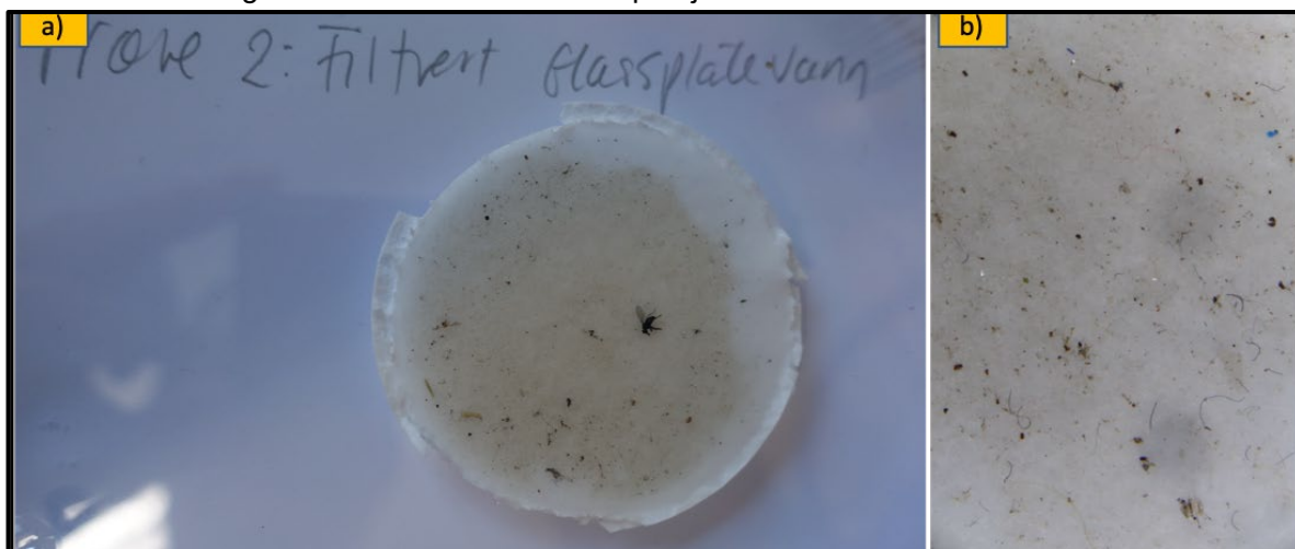
Figur 8. Vann filtrert gjennom glassfiberfilter. a) glassfiberfilter der man kan skimte innsamlede fragmenter med det blotte øyet, b) minste forstørrelse av glassfiberfilteret med lupe.
