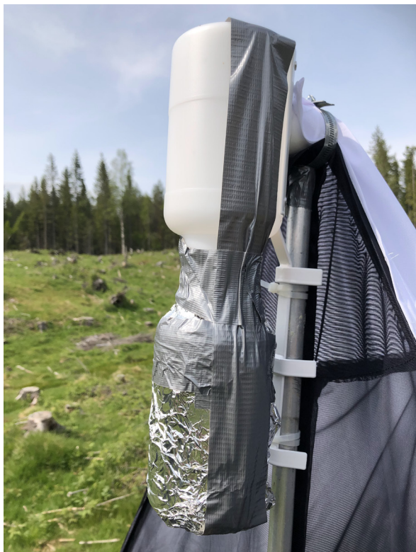
Figur 4. Nærbilde av innsamlingsbeholder til Malaisefeller. Aluminiumsfolie brukes for at minke fordamping og forhindre nedbrytning av DNA fra sollys.
