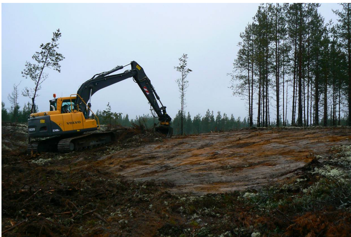
Mekanisk restaurering av sandområde gjennom avskraping av humus og vegetasjon i syd- vendte skråninger ved Brattforsheden, Värmland i Sverige. Foto: Sven-Åke Berglind.
