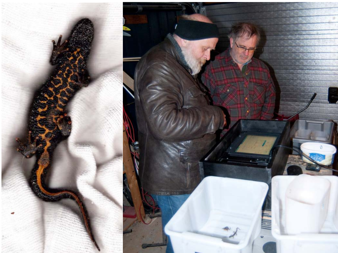
Figur 5.3. Scanning av bukmønster hos storsalamander, skanner og PC til høyre og resultatet av scanningen til venstre. Scanneren er en ombygd passfotoscanner bygd sammen med en bærbar PC. Det er utviklet en database som gjør det mulig å lagre lengde, vekt, kjønn, bilde og funnsted (geografisk posisjon). Skjermen er trykkfølsom og gjør det enkelt å bruke scanneren i felt. Se side 40 for nærmere beskrivelse. ©Foto: Jan Mjåland (tv) og Børre K. Dervo (th).
