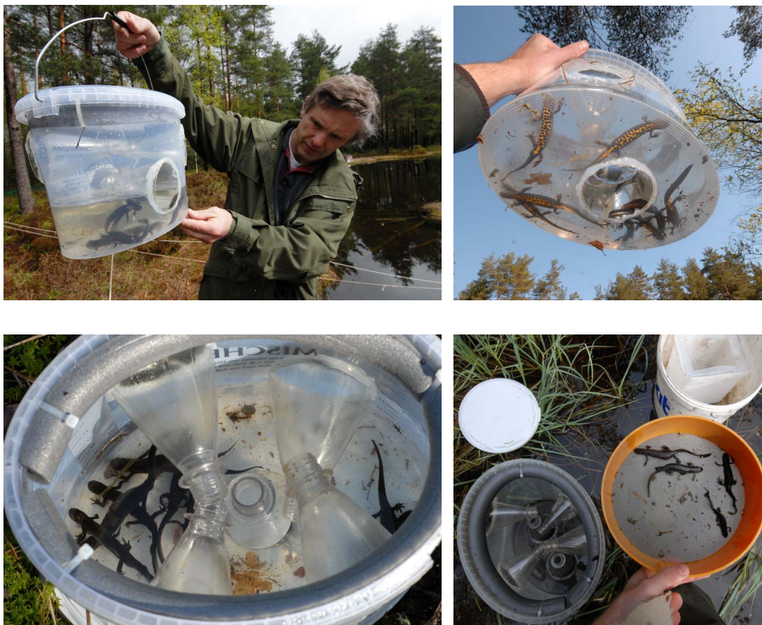
Figur 4.7. Ortmannfellen utvendig (oppe tv), under (oppe th), innvendig (nede tv) og åpnet felle med sil (nede th). ©Foto: Jeroen van der Kooij.
