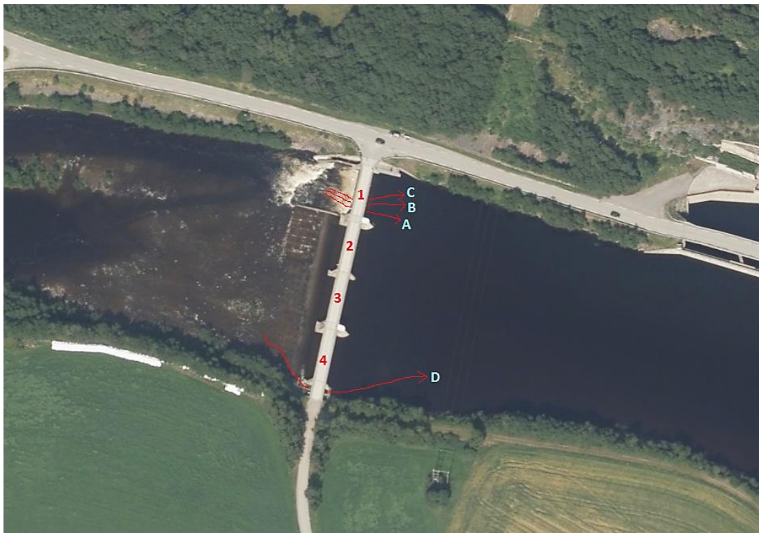
Figur 1. Flyfoto av Bjørsetdammen med de fire åpningene (lukene) i dammen, nummerert fra 1 til 4. Fisken passerer hovedsakelig i åpning 1. Her velger fisken ulike vandringsruter marker med A, B og C, men over 80 % vandrer langs rute A. Det kan også vandre fisk i fisketrappa på vestsiden av dammen (vandringrute D). Hver av åpningene 1 til 4 er utstyrt med reguleringsluker som kan legges ned. Lukene i åpning 2 til 4 er kun åpne ved flom og representerer ikke et reelt vandringsalternativ. Flyfoto er lastet ned fra www.finn.no .
