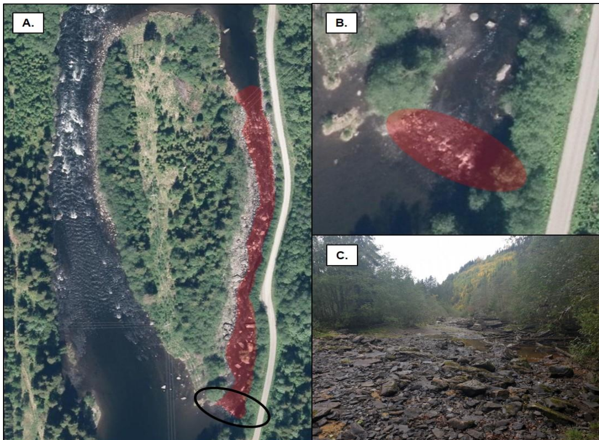
Figur 6. A. Flyfoto av sideløpet nedstrøms Brattset kraftverk skravert med rødt med innløpet omringet i svart. B. Flyfoto med innløpet skravert med rødt. Vannføringen på dette tidspunktet var tilstrekkelig for å sikre vannstrøm gjennom sideløpet. C. Bilde fra innløpet under en situasjon nær minstevannføring der elveløpet går tørt. Foto: Marius Berg, NINA. Flyfoto er lastet ned fra www.finn.no/kart .
