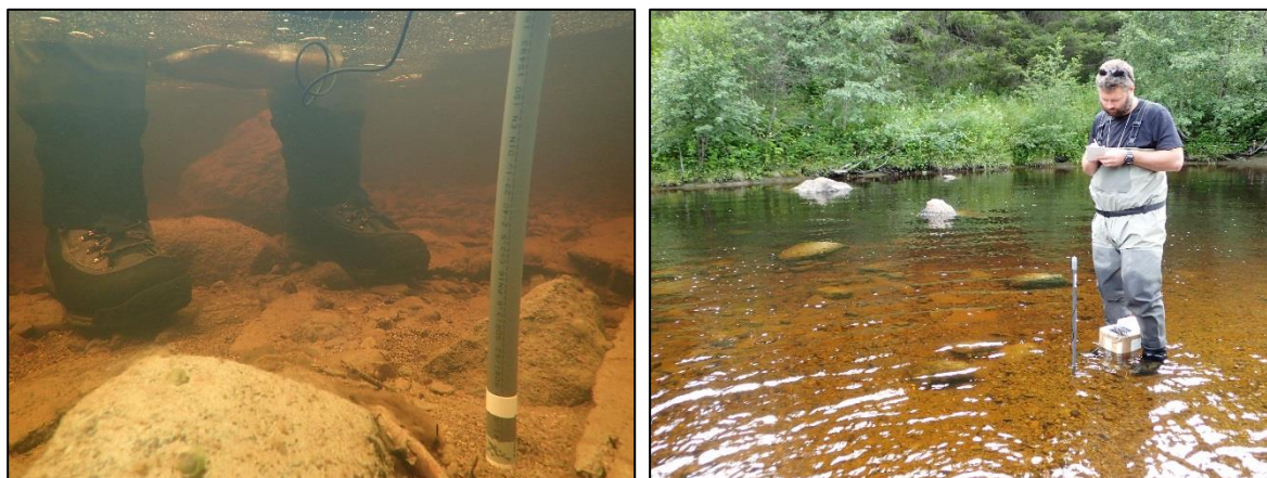
Figur 15. Måling av redokspotensiale i substratet. Illustrasjonsfoto fra et annet vassdrag: Bjørn Mejdell Larsen.
