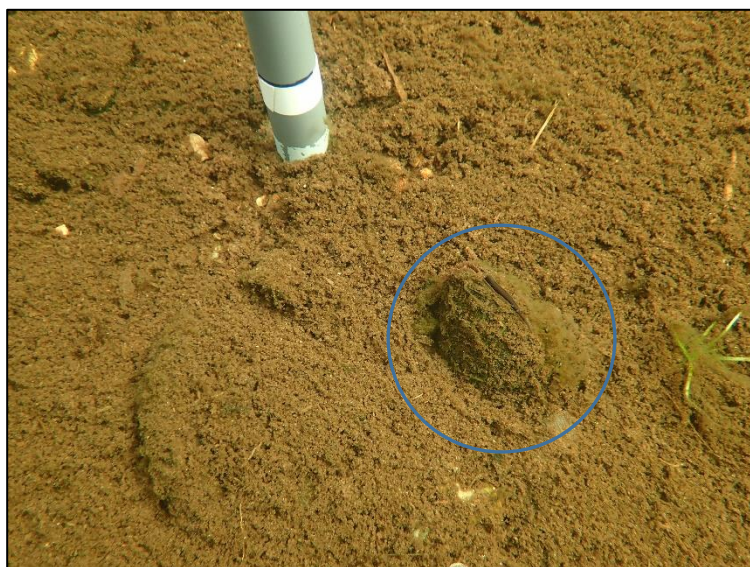
Figur 24: Redoksmåling på stasjon R3 i et område nedenfor Makkhølen der det ble funnet to muslinger i august 2018 (én av dem er markert på bildet). Jordslammet som dekker bunnen forårsaker dårlig vanngjennomstrømning i substratet og oksygensvinn. Foto: Bjørn Mejdell Larsen.
