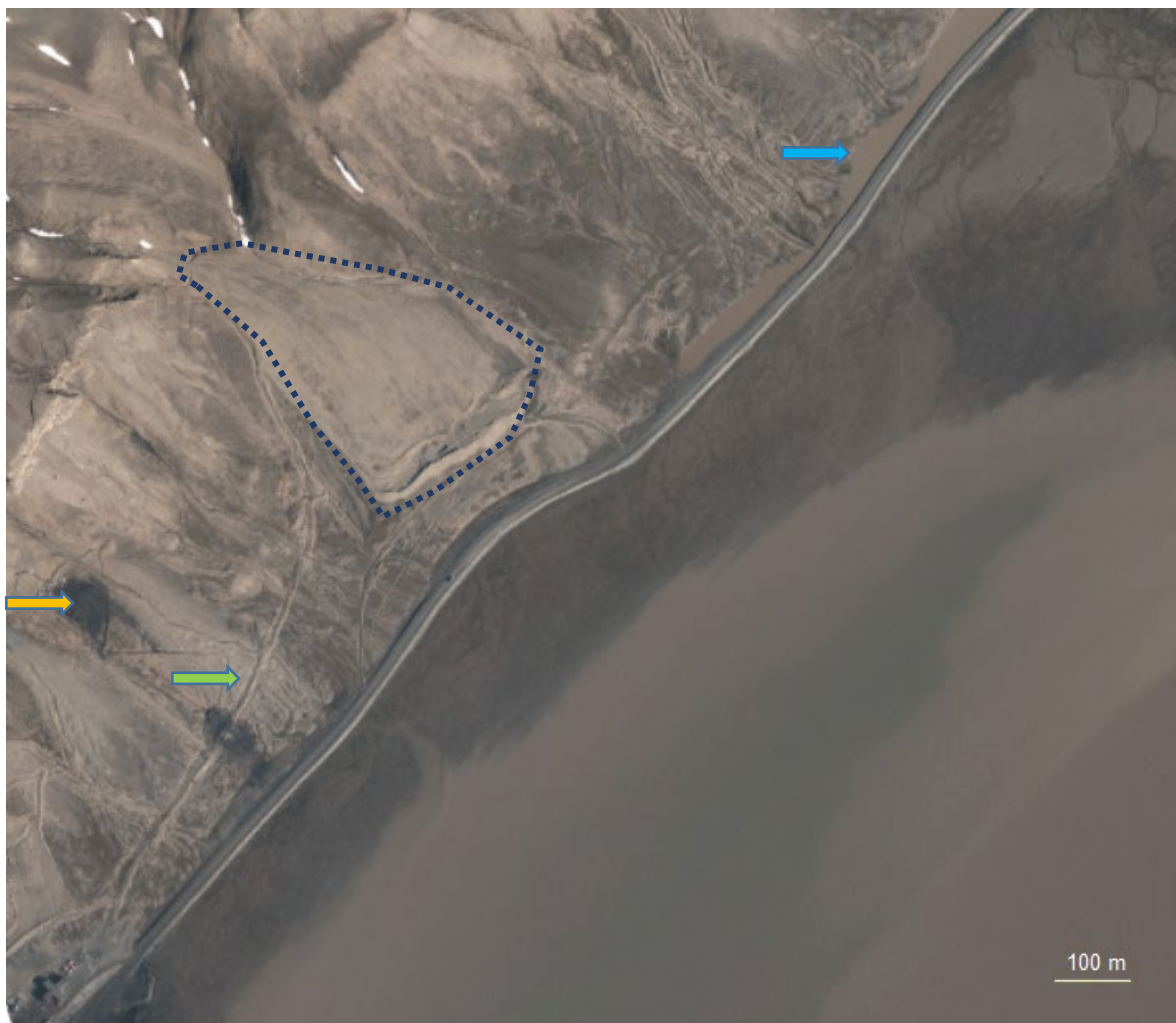
Figur 3.10. Strandveien ved Braganzavågen. Blå pil viser hvordan veien blir som en demning med vann på innsiden. Gul pil viser inngrep etter gruvedrift, grønn pil viser kjørespor i terrenget. Stipla område med inngrep i overflata.
