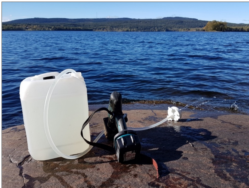
Figur 2. Filtrering av 10 liter vann med Bürkle Vampire peristaltisk pumpe ved Maridalsvannet i Oslo. Foto: Tor Atle Mo/NINA.
