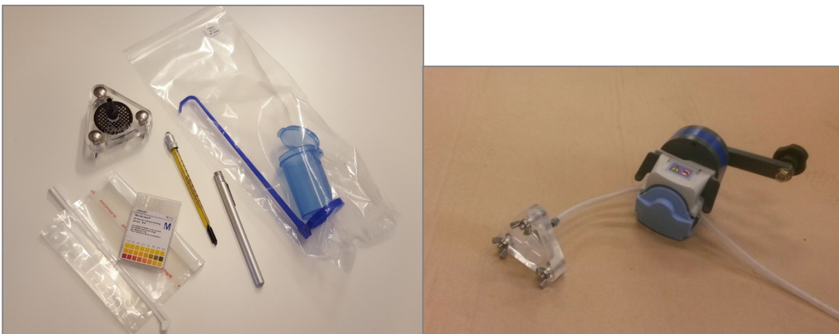
Figur 1. NINA prøvetakingsutstyr og hånddrevet peristaltisk pumpe. Foto: Frode Fossøy/NINA.
