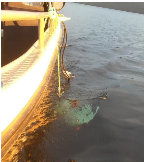
Figur 3. Vingen med ekkoloddsvingeren ble tauet på siden av båten på 1 m dyp. Foto: Karl Øystein Gjelland.
