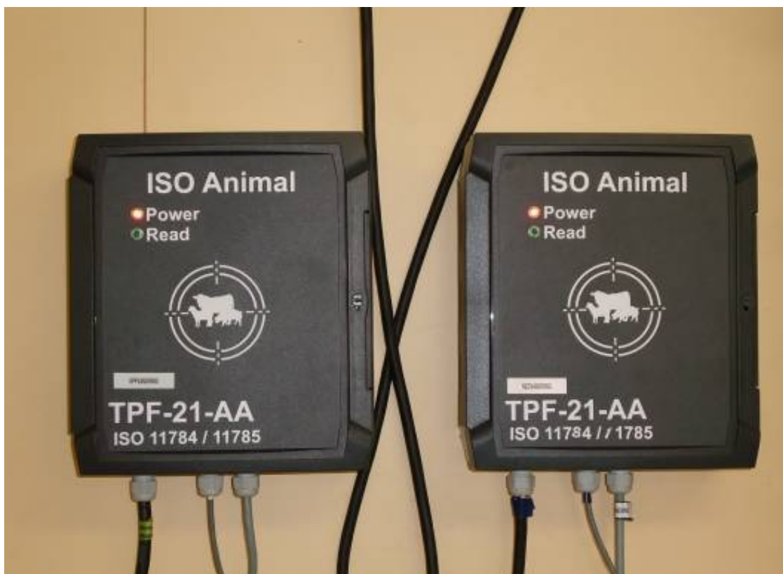
Figur 6. Koblingsboks (for ned- og oppvandring) på innsiden av fellehuset.
