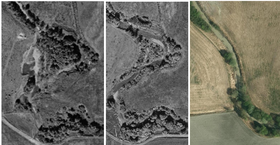
Bilde 29. Flyfotoserie fra parti i Leirbekkens anadrome strekninger ovenfor Fv 65. Flyfoto fra 1957 (t.v.) og 1962 (midten) viser naturtilstanden, med svært egnede vassdragskvaliteter for laksefisk, og 2013 (t.h.) en utrettet, senket kanal som har mistet alle naturlige egenskaper.
