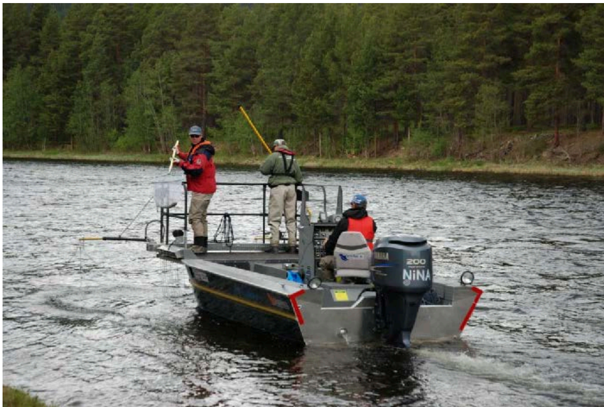
Bilde 2. En elektrisk fiskebåt ble brukt til innsamlingen av laksunger i Drammenselva og Drammensfjorden i september 2017. Foran har båten en plattform med et solid gjerde for personer som håver strømbedøvet fisk og midt i båten er det et akvarium der innsamlet fisk holdes levende fram til prøvetaking. Foto: Jon Museth.
