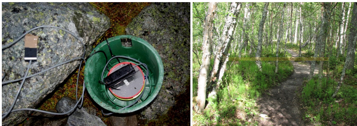
Figur 2.7 EcoCounter teller (sensoren er den svarte/brune firkanten til venstre og batteri/minne-enhet er plassert i den grønne bøtta), til venstre. Eksempel på plassering / registreringsstråle, til høyre.
