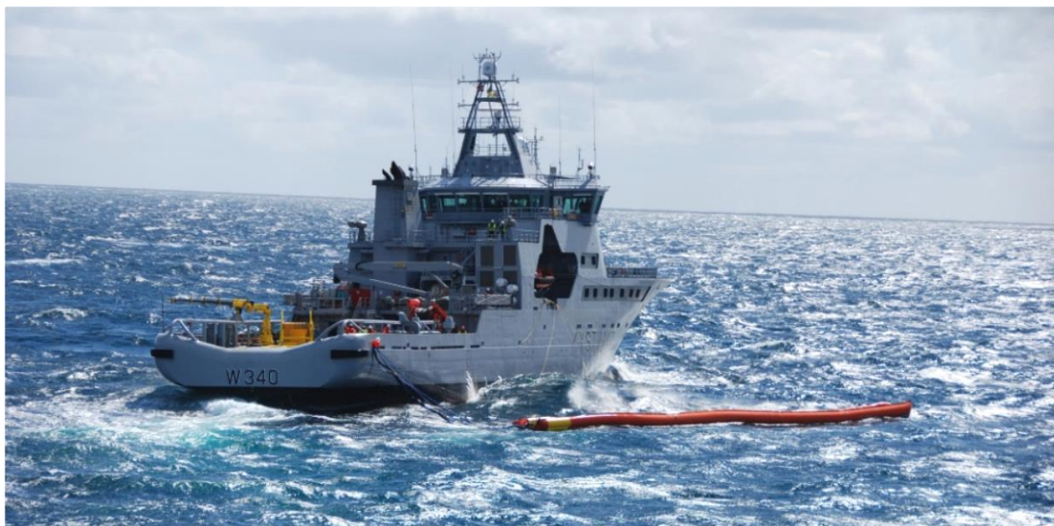
Figur 5.3. Oljevernøvelse i regi av NOFO i 2012: Testing av nye og lovende lenseystemer, som kan få betydning for oljevernet i Vega (Foto: Arne Follestad, NINA).
