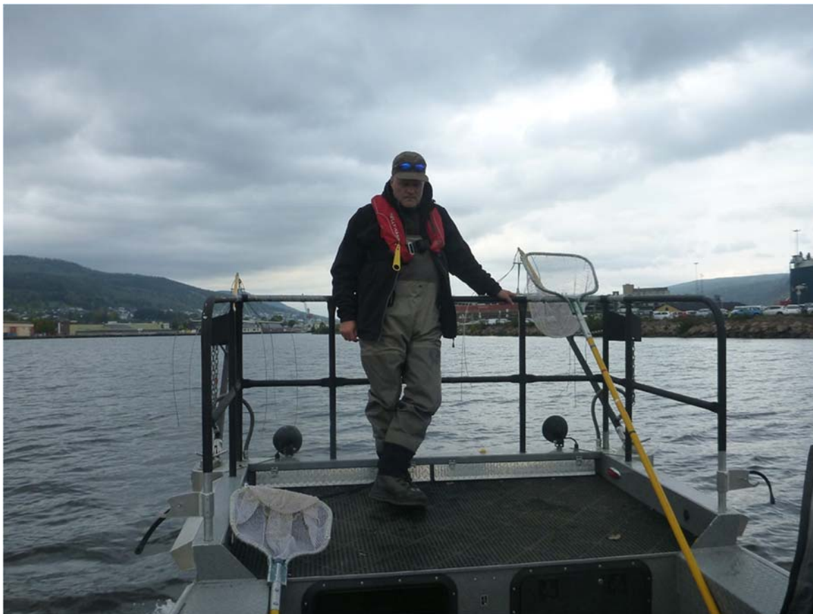
Bilde 1. Fremre del av elfiskebåten som ble brukt til innsamlingen av siki. Foran har båten en platting med et solid gjerde for personer som håver strømbedøvet fisk. I bakgrunnen sees Strømsløpet som utgjør det sørlige utløpet av Drammenselva til Drammensfjorden.
