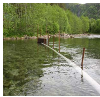
Bilde 1. Rør fra øvre til nedre fangstkasse, slik som det ble montert i 2007. Bildet til venstre viser innsiden av øvre fangstkasse. Bilde til høyre viser nedre fangstkasse, som stod nærmere land og på roligere vann. På bildet i midten ser en oppover mot øvre fangstkasse.
