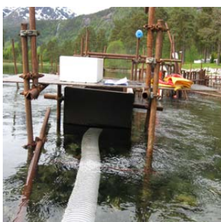
Bilde 1. Rør fra øvre til nedre fangstkasse, slik som det ble montert i 2007. Bildet til venstre viser innsiden av øvre fangstkasse. Bilde til høyre viser nedre fangstkasse, som stod nærmere land og på roligere vann. På bildet i midten ser en oppover mot øvre fangstkasse.
