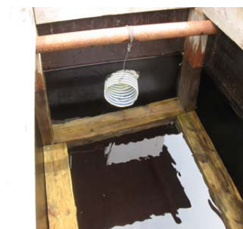
Bilde 1. Rør fra øvre til nedre fangstkasse, slik som det ble montert i 2007. Bildet til venstre viser innsiden av øvre fangstkasse. Bilde til høyre viser nedre fangstkasse, som stod nærmere land og på roligere vann. På bildet i midten ser en oppover mot øvre fangstkasse.
