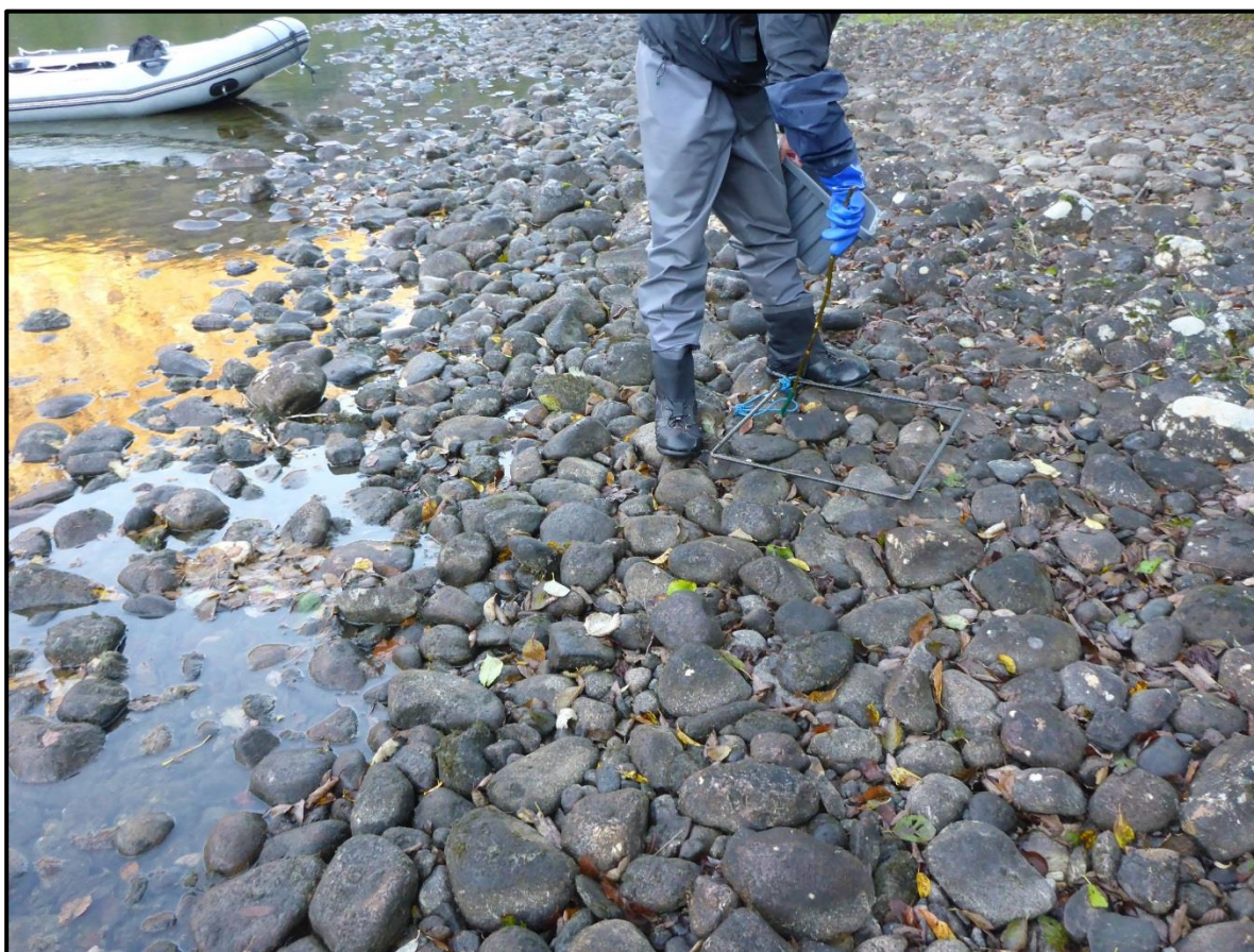
Bilde 5. I områder med flat tverrprofil ble det også gjort habitatkartlegging på områder som ikke er permanent vanndekt. Hulrom innenfor et definert areal ble identifisert etter metodikk utarbeidet av Finstad et al. (2007) ved å bruke en fleksibel PVC-slange. Foto: Jan Gunnar Jensås.
