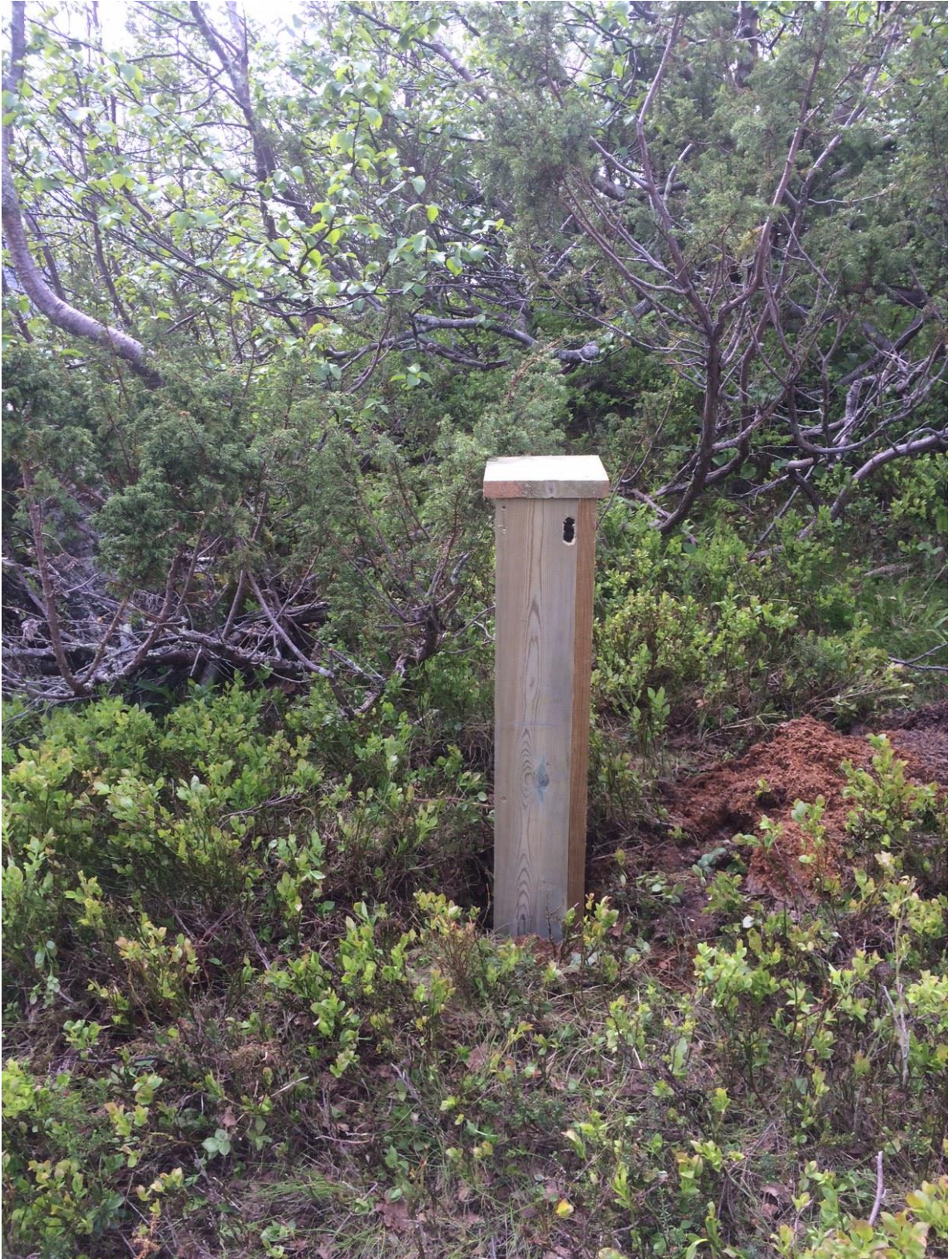
Figur 3 Ferdsestiller montert i stolpe, ved Nedalshytta. Foto: Jon Moen.
